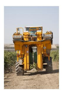
عند اشتغال الجهاز من الأحسن عدم اقتراب ولمس الأجزاء التي تعمل أو تدور لأنه من المستحيل حمايتها وتغطيتها .
